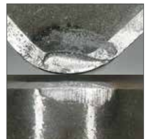
Herkömmliches Werkzeug (unbeschichtet) (nach 0,5 km)
