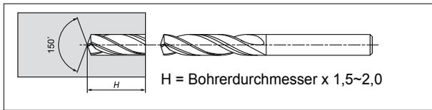
2. Beginnen Sie die Bohrung mit dem XHGS-Tieflochbohrer bei einer geringen Drehzahl.
