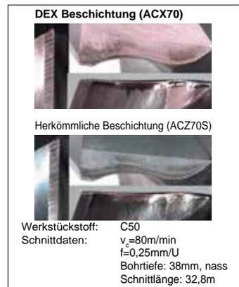
**MTL-Typ** Geometrie mit stabiler Schneidenecke und großer Schneidkantenverrundung, besonders geeignet für das hocheffiziente Bohren von Stahl.
