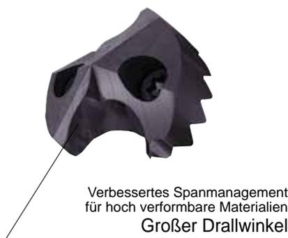
Das Werkzeugdesign ist auf die Bearbeitung großer Gehäuse z.B. aus Kugelgraphitguss abgestimmt. Das Schneidendesign wurde so optimiert, dass die hohen Schnittkräfte, die bei großen Bohrungen auftreten, reduziert werden.
