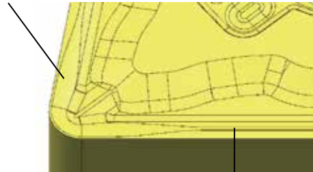
Reduzierter Korbverschleiß durch gerade Schneidkante.
